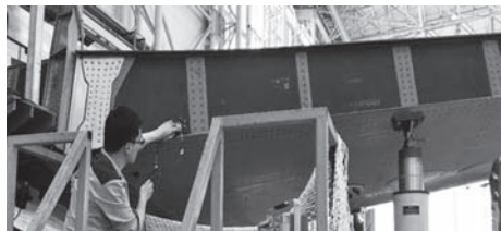
图7 复材机翼装配现场超声应力测量
